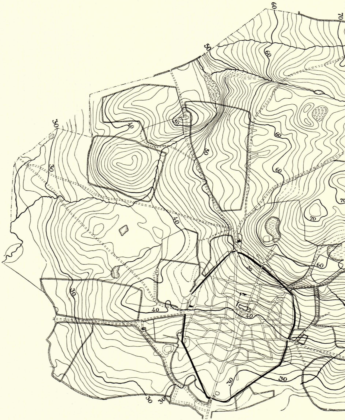
Plansch 2. Avvågningskarta över Lund. Höjdkurvorna efter stadsingenjörskontorets avvågningshågnader och vattendrag skisserade efter 1704 års karta. Krysset på Mårtens fälad anger p
